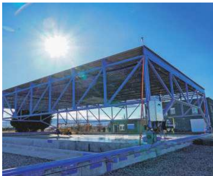
El simulador de lluvias instalado por el Canal de Isabel II en Meco. CANAL DE ISABEL II
